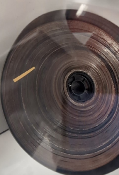
IMÁGENES 6, 7 Y 8 ▲ PELÍCULAS DE NIVEL DE ACIDEZ 3 AFECTADAS POR POLVO, ÓXIDOS Y RESIDUOS, Y SUS LATAS DE ALMACENAMIENTO ORIGINALES.
