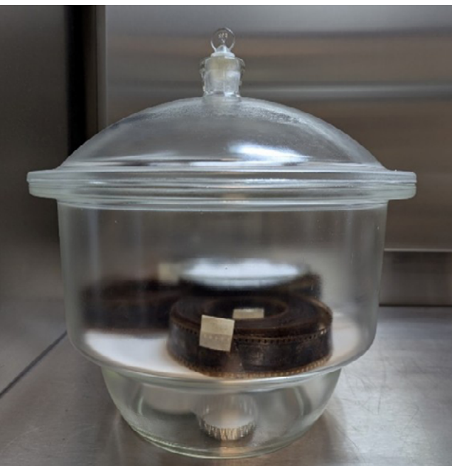
IMAGEN 9 ▼ DESECADOR CON LAS PARTES HÚMEDAS DE UN ROLLO. PROCESO DE SECADO CON AGENTES DESECANTES.
