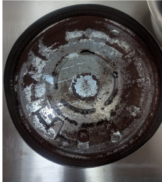
IMÁGENES 6, 7 Y 8 ▲ PELÍCULAS DE NIVEL DE ACIDEZ 3 AFECTADAS POR POLVO, ÓXIDOS Y RESIDUOS, Y SUS LATAS DE ALMACENAMIENTO ORIGINALES.
