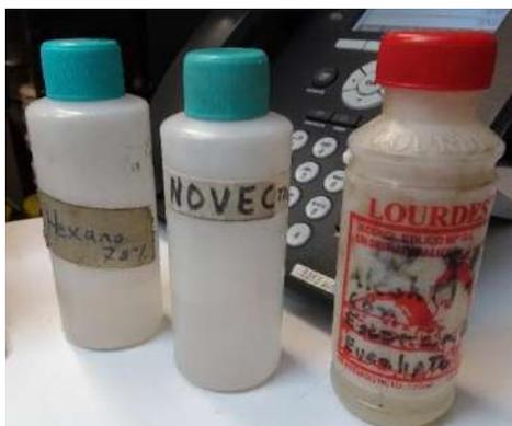
En el caso de los fotogramas, solo se limpiaron cuidadosamente con esencia de eucaliptus-alcohol isopropílico, con un hisopo de algodón, al tratarse de materiales de nitrato muy antiguos con un proceso de coloración por teñido.
