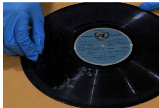
Foto: Disco limpiado manualmente con cepillo de fibra de carbón
