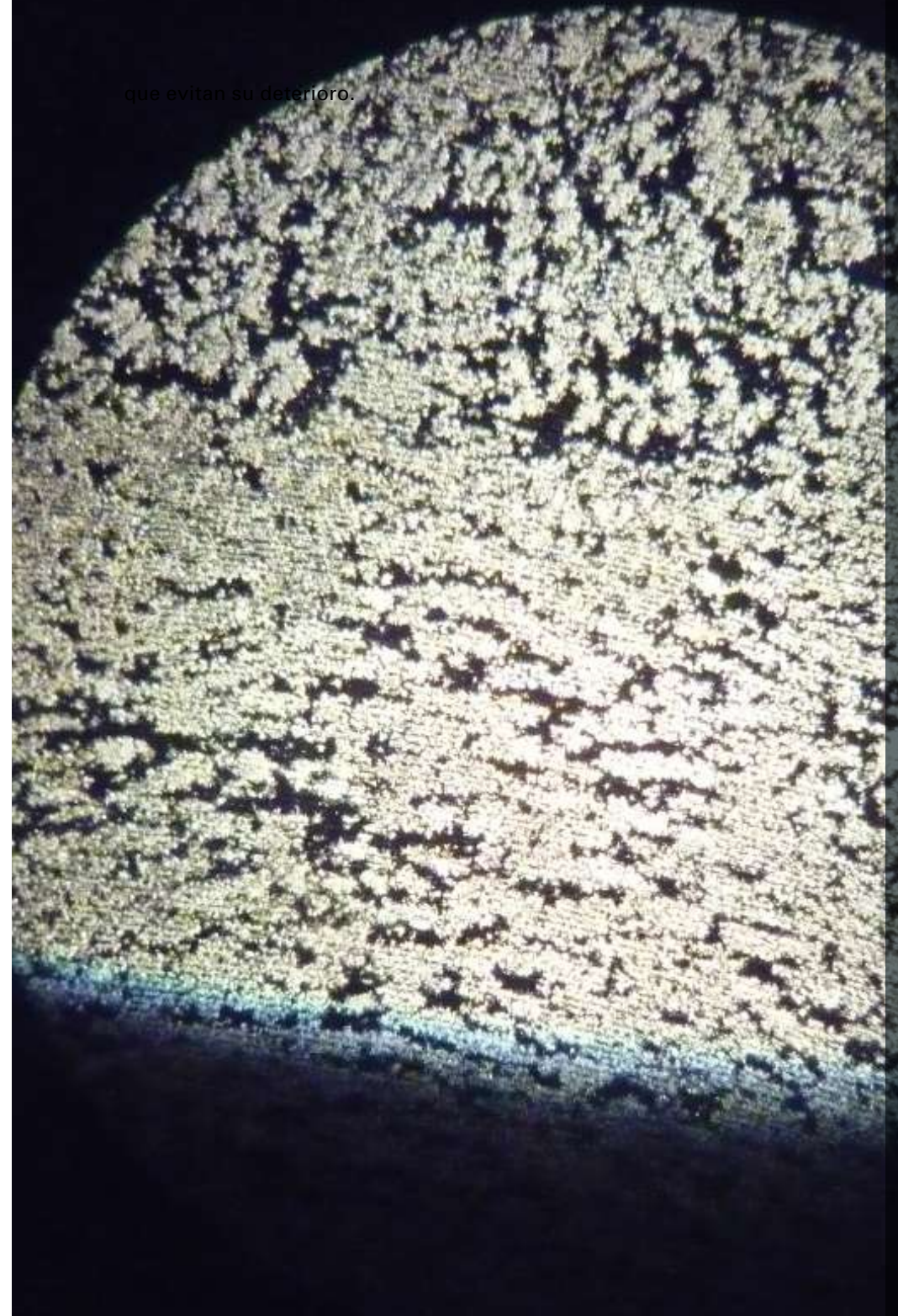
Foto: Deterioro de un disco analógico visto al microscopio © Fonoteca Nacional / Celene Eslava Rojas
